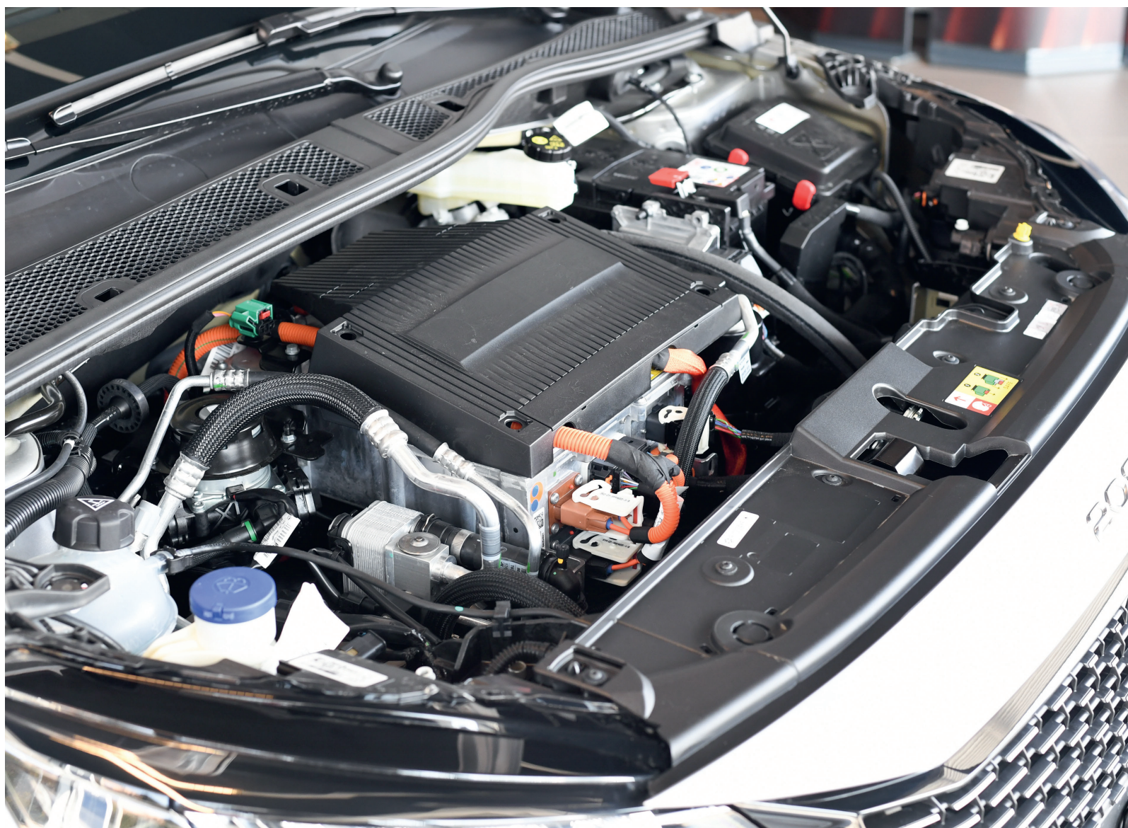
Les véhicules électriques modernes sont généralement équipés d'onduleurs complexes pour convertir le courant continu de la batterie en courant alternatif triphasé. PHOTO STÉPHANE GERBER
